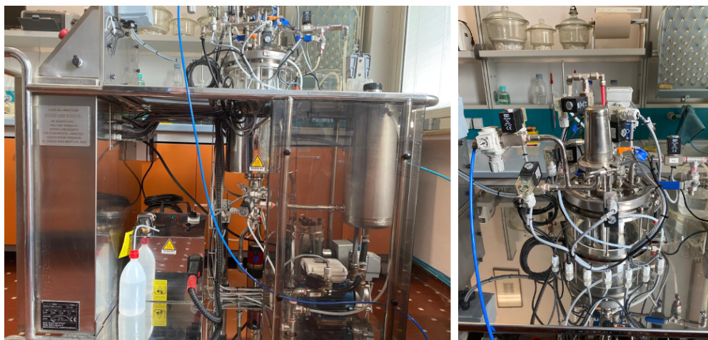
Fig. 7 Bioreattore pilota impiegato per la produzione della biomassa di K. phaffii X3- \beta CSN.
